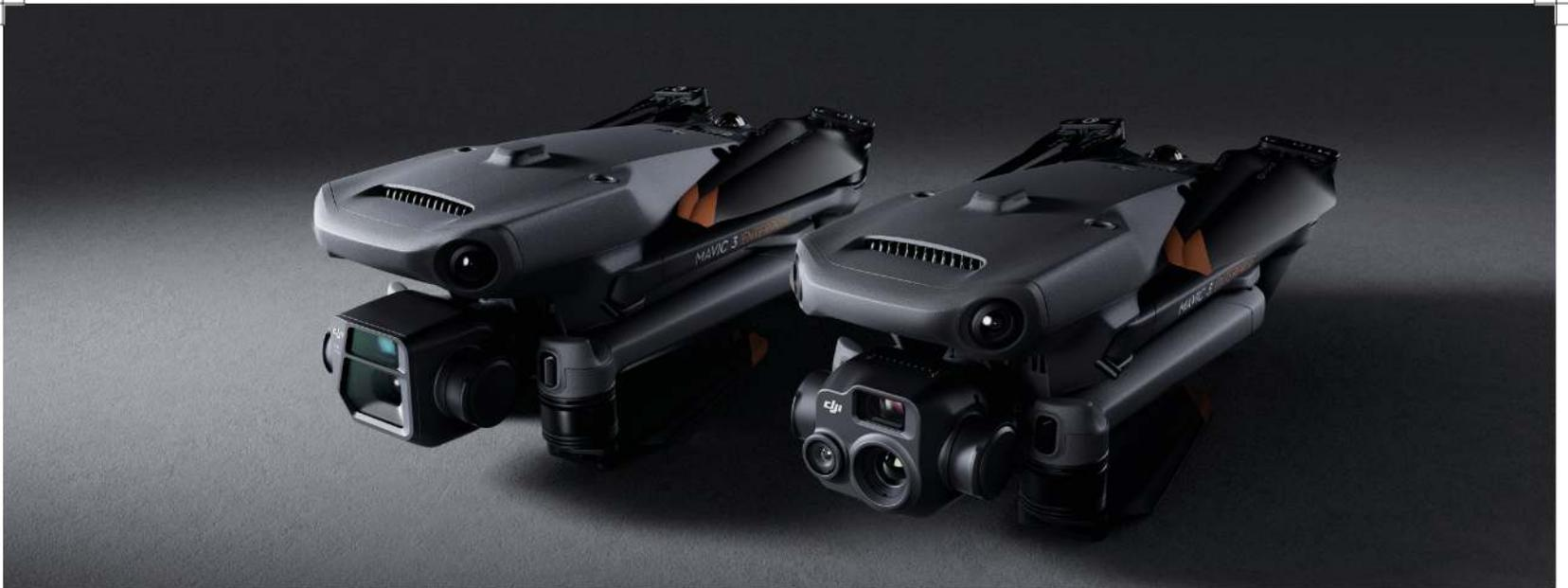
Mavic 3 Enterprise ridefinisce gli standard del settore dei droni commerciali di piccole dimensioni. Con un otturatore meccanico, una fotocamera con zoom 56x e un modulo RTK per una precisione di livello centimetrico, Mavic 3E porta l'efficienza di ogni missione a un livello superiore. È disponibile anche una versione termica per operazioni antincendio, di ricerca e soccorso, ispezioni e operazioni notturne.
